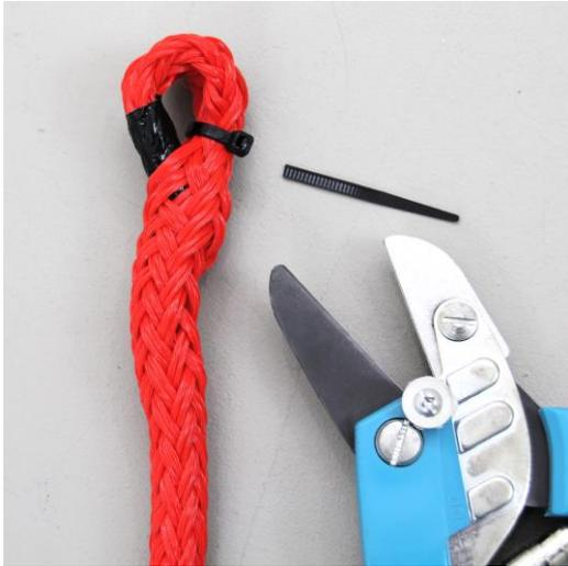
6. Das dicke Ende vom Kabelbinder auf die Innenseite der Strippe drehen und das Strippenende wieder schließen:
